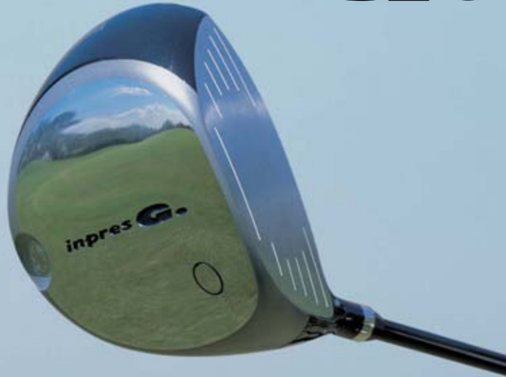
2.5mm鍛造βTi(SAT2041)フェース+鍛造ボディ(フェース周辺薄肉2.0mm)
